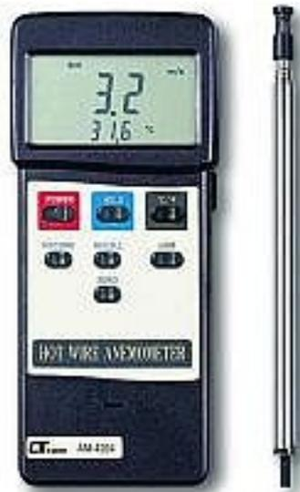
Per il monitoraggio degli aspiratori per polveri basta avere un apparecchio con sensibilità alla prima cifra decimale, per il controllo delle cappe sterili serve una maggiore precisione, alla seconda cifra decimale.
